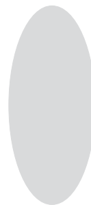
Traccia simmetrica di spruzzatura Airless con l'assistenza dell'aria. Non vi è nessun tipo di coda.
