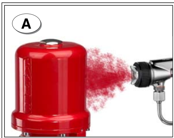
Traccia della spruzzatura di un fluido a bassa pressione senza l'ausilio di aria
