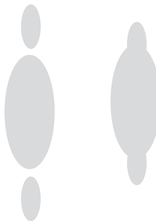
Traccia della spruzzatura di un fluido a bassa pressione senza l'ausilio di aria
