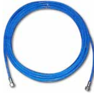
TUBO ANTI-ESTÁTICO 3/16" - M16x1,5 pressão max. 210 bar Art. 6164: 5 mt Art. 55050: 7,5 mt Art. 35018: 10 mt
